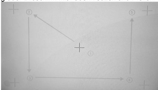
6. Tippen Sie mit dem Finger auf das dunkler dargestellte Kreuz in der Mitte und halten gedrückt, bis es mit einem Signalton zur nächsten Position (links oben) springt.
