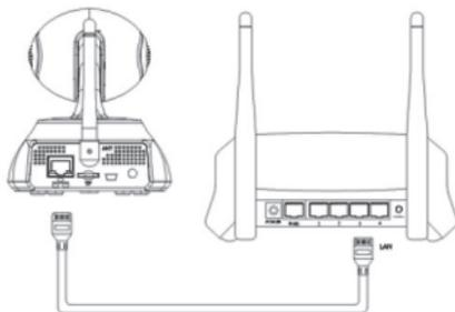
4. Lorsque la connexion est établie, la LED jaune du port LAN brille et la LED verte du port LAN clignote.
